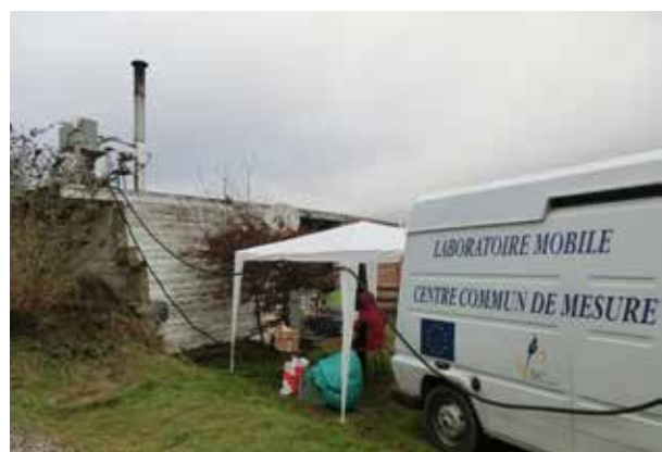
Prélèvements et analyses sur site des émissions d'une chaufferie Biomasse.
