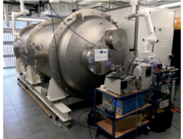
Illustration n°1 : Chambre de simulation atmosphérique pour l'étude de la réactivité des gaz et des particules atmosphériques. LPCA - Université du Littoral Côte d'Opale, Dunkerque.
