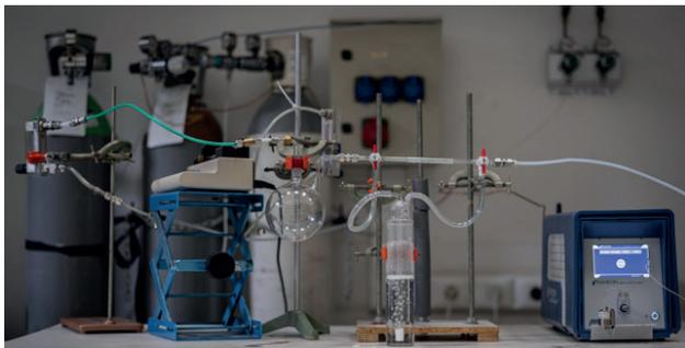
Dispositif permettant l'étude de l'absorption des différents constituants du biogaz dans les solvants à l'échelle du laboratoire (montage développé en partenariat avec le Centre Commun de Mesures de l'ULCO).
